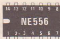
Fig. 7 Disposizione dei terminali dell'integrato NE556. I piedini di alimentazione sono il 7 (-) ed il 14 (+).
